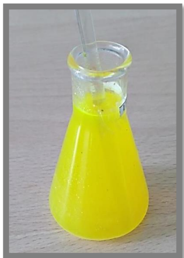
Фото. 6 Ацетат свинца с активатором флуоресцеин
