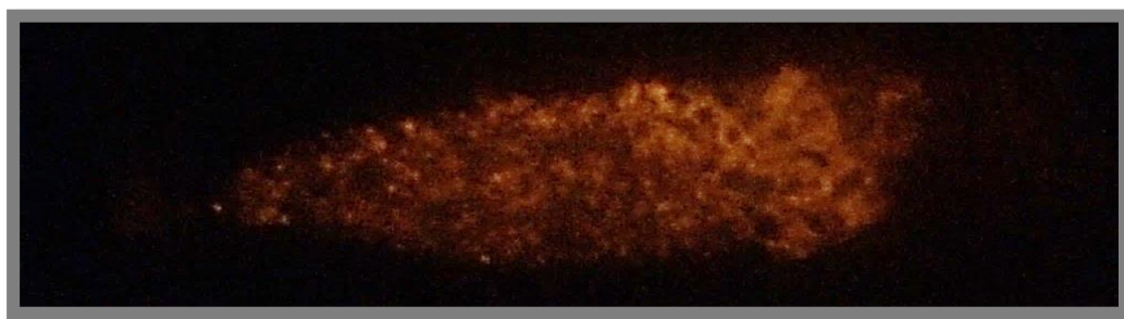
Фото.17 Люминофор сульфид бария/ионы меди (низкая концентрация)
