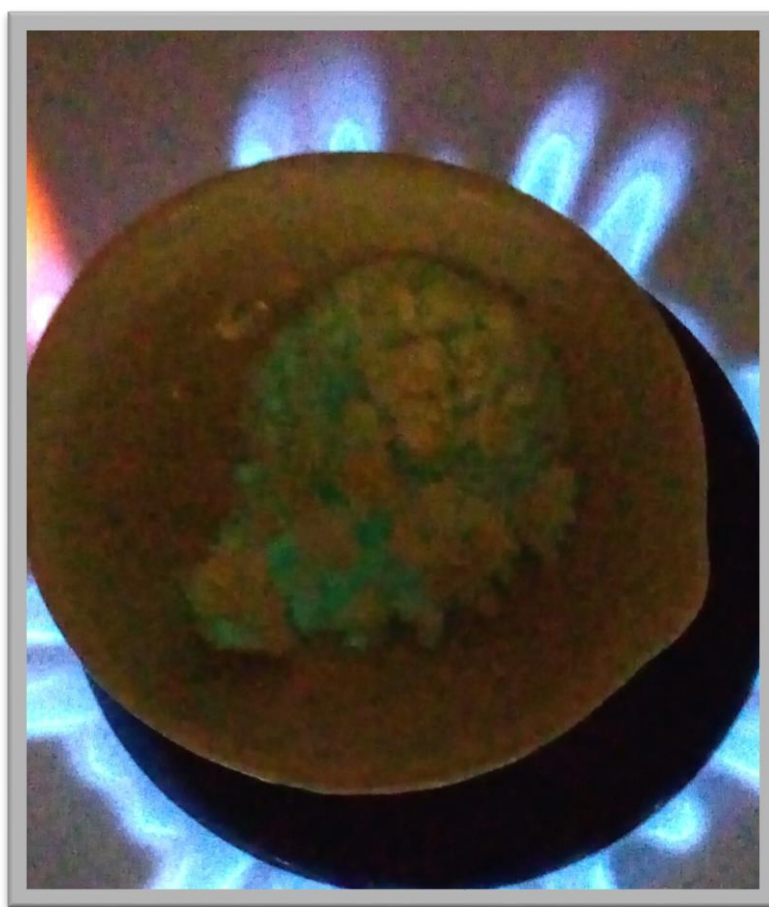
Фото.26 Свечение сульфидного люминофора от нагревания
