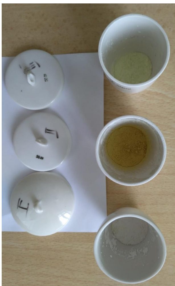
Фото.15 Смеси для синтеза люминофоров перед обжигом в печи
